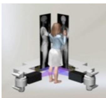
Issue des travaux du prix Nobel de physique G. Charpak (1992), cette technologie de pointe a été conçue par une entreprise française, EOS imaging, pour fournir une radiographie du corps entier de face et de profil en 30 secondes, à des doses de radiation inférieures de 50 % à 85 % à celles des systèmes standards de radiologie, soit une sécurité renforcée pour le patient.
